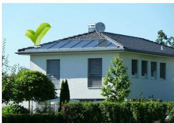
**2.1** Solaranlagen sind dachbündig einzubauen, jedenfalls darf der Kollektoraufbau maximal 20 cm betragen. Dieser wird im Bereich der Anlage rechtwinklig zur Dachfläche bis zur Oberkante der Anlage gemessen.
